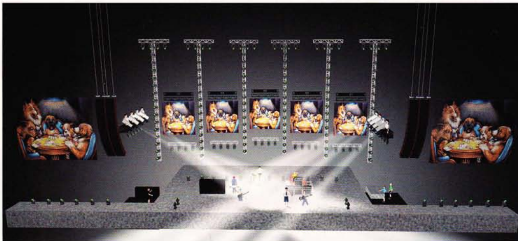
Für die Shows wurden fünf bewegliche LED-Wände nebeneinander positioniert, während sonst in den USA acht Stück kreisförmig über der Bühne hängen
